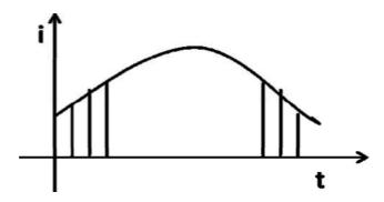
$$I_{rms} = \sqrt{\frac{i_1^2 + i_2^2 + \dots + i_n^2}{n}}$$
