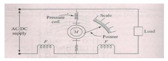
Fig. 7.5.2(b) Schematic of dynamometer type wattmeter
